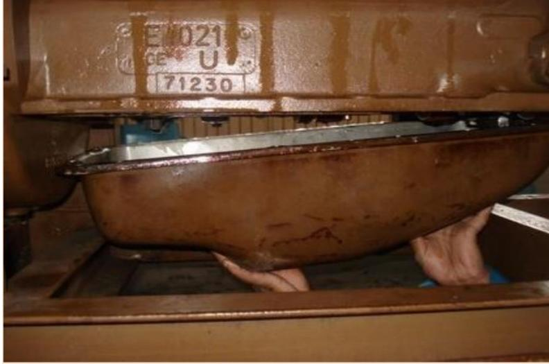
الشكل 11: طريقة فتح خزان الزيت.
