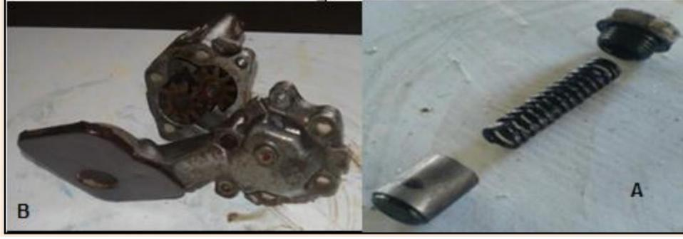
الشكل 15: A : تفكيك صمام الأمان في مضخة الزيت، B: تفكيك مضخة الزيت.
